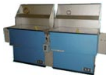
Dégraissage de composants, mécaniques en immersion, à froid ou à chaud
